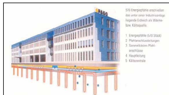
Abbildung 6: Schema erdberührte Betonbauteile.
